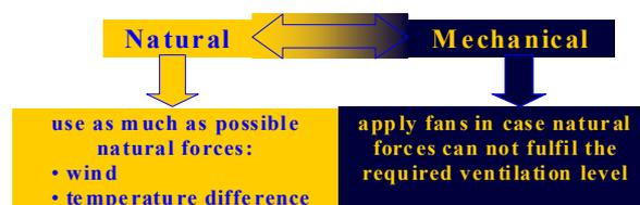
Figure 1 : Représentation schématique des 2 modes de la ventilation hybride
