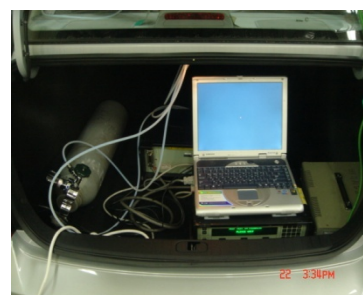
Figure 7. Méthode de mesure de l'air intérieur en mode « circulation »
