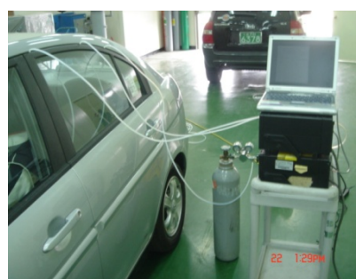
Figure 6. Méthode de mesure de l'air intérieur dans une voiture en mode « arrêt »
