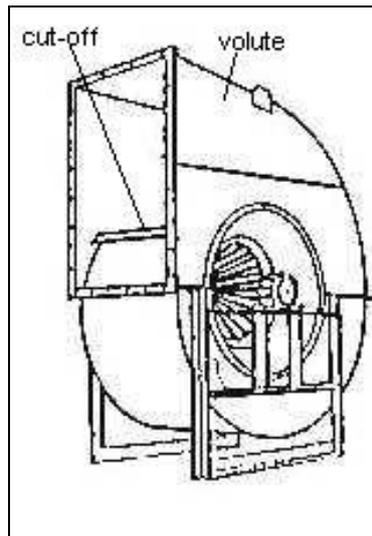
**Figure 4** Centrifugal fan
