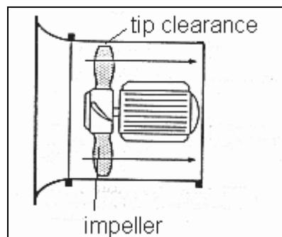
**Figure 2** Axial flow fan
