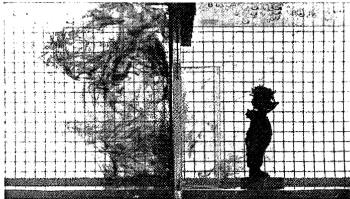
Fig. 6 Stroming kort nadat een persoon de deuropening is gepasseerd in de isotherme toestand zonder 'ventilatie'
