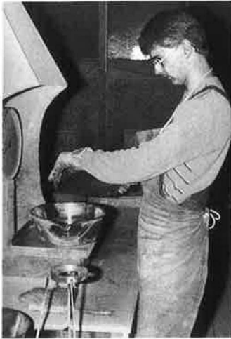
Bild 4. Dosieren der pulverförmigen Stoffe mit den Fingern – Istzustand
