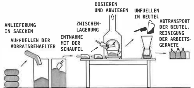
Bild 2. Arbeitsschritte bei der Handverwiegung von pulverförmigen Stoffen – Istzustand
