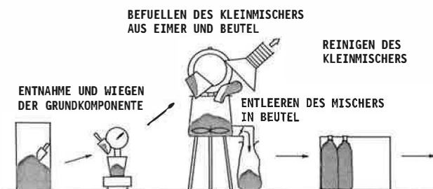
Bild 7. Arbeitsschritte beim Mischen pulverförmiger Stoffe
