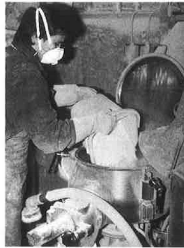
Bild 8. Befüllen des Kleinmischers mit einem Eimer – Istzustand
