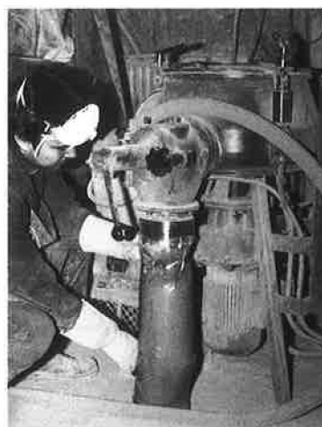
Bild 9. Entleeren des Kleinmischers in Kunststoffbeutel – Istzustand
