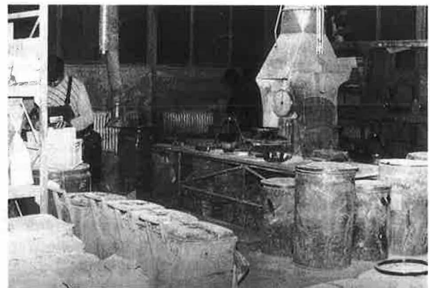
Bild 3. Arbeitsplatz zum Handverwiegen von pulverförmigen Stoffen mit Vorratsbehältern, zwei Arbeitstischen, zwei Waagen, Absaughauben und Arbeitsgeräten – Istzustand
