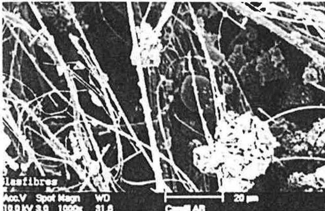
5. Media filtrant fin type opacimétrique. Fibres de verre diamètre 1 à 3 µm (se souvenir ici que l'efficacité est fonction inverse du diamètre des fibres...), en cours de colmatage.
