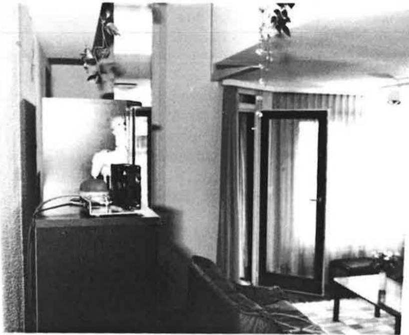
Figure 2.9 : Appartement : ventilateur pour l'injection et le mélange du gaz traceur.
