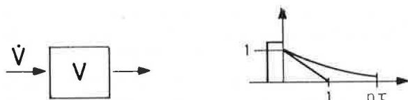
Fig. 3 — Mélange parfait. La probabilité de trouver le traceur injecté est au temps \tau constante dans tout le volume.
