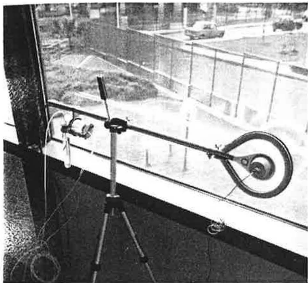
figura 8 - Il radiometro tipo CN2 in posizione di misura parallelamente alla facciata interna del vetro-camera
