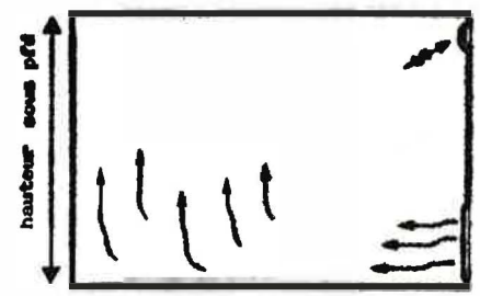
Fig. 2. Mouvement de l'air avec système à déplacement d'air.
