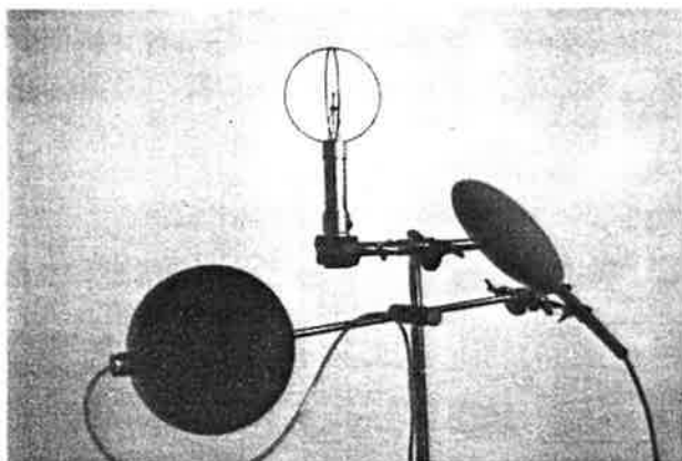
Foto 7: In totaal zijn ruim 100 opnemers aangebracht die met een computergestuurd data-acquisitiesysteem zijn verbonden. Hier enkele sensors op het referentiepunt.
