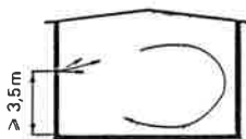
Bild 5: Mögliche Einbausituationen der Weitwurfdüsen
