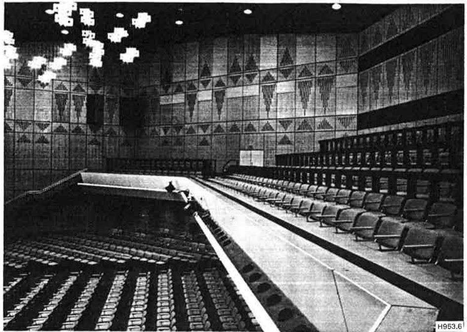
Bild 6: Eurogroß Aachen, Weitwurfdüsen in der Empore
