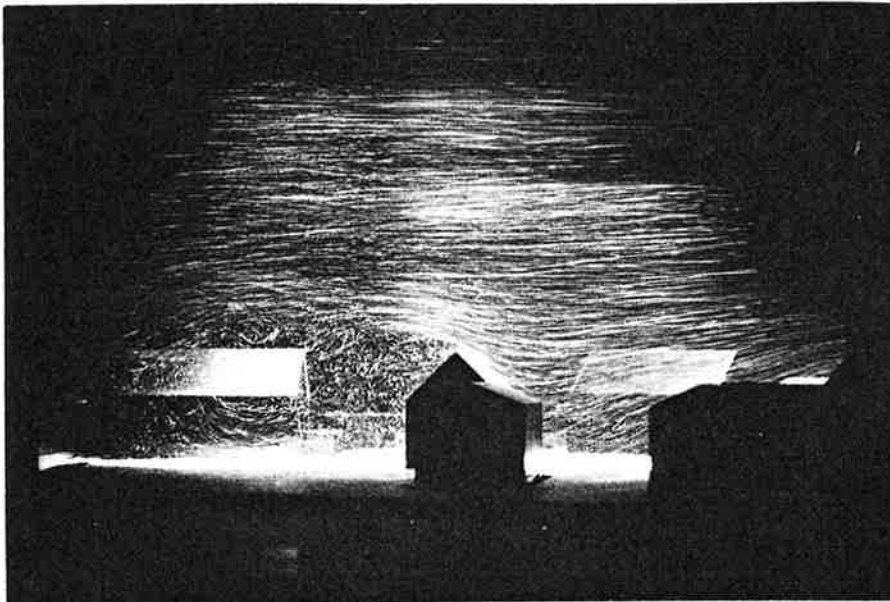
Visualisation par chronophotographie des écoulements au contournement d'obstacles bâtis
