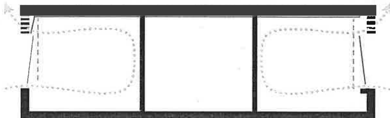
European Patent Office, Rijswijk: geheel natuurlijke dwarsventilatie als basis. Zomerventilatie door twee te openen ramen boven elkaar
