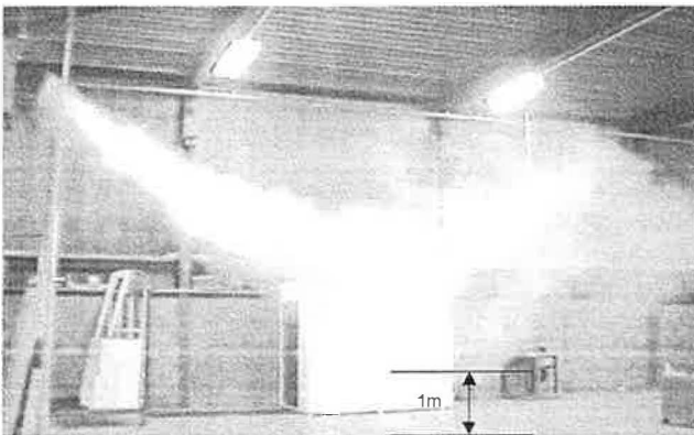
Afbuigen van de opstijgende warme lucht met ondersteuningsventilator ter voorkoming van hot-spot aan het dak.
