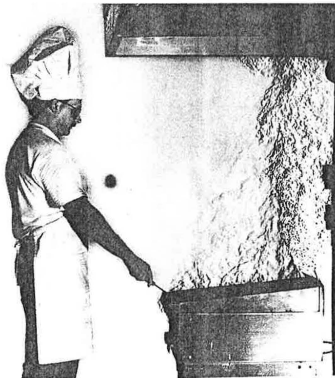
Figura 3 - Un piano di cottura di una cucina ad uso industriale e un aspiratore a cappa in uso, con vapori di cottura visibili tramite la tecnica schlieren
