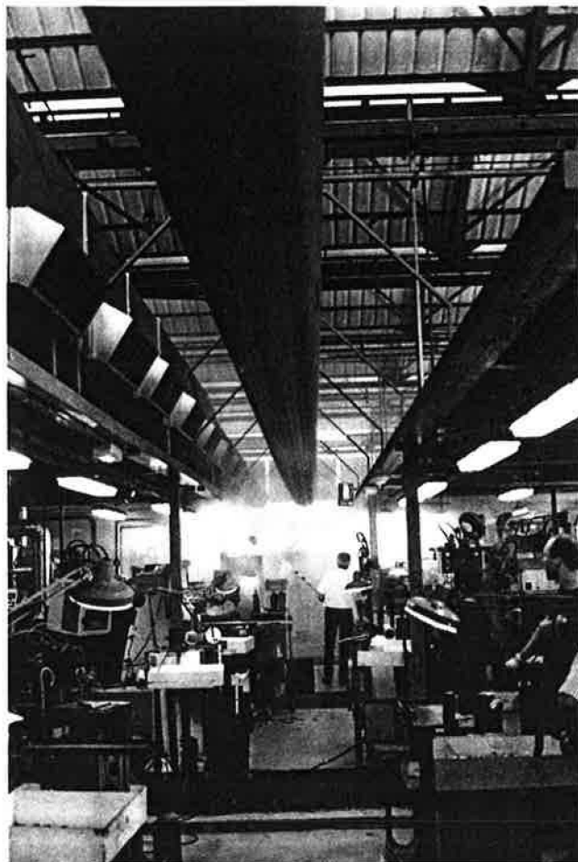
Figura 7 - Prova con fumo diffuso in prossimità del confine del tunnel
