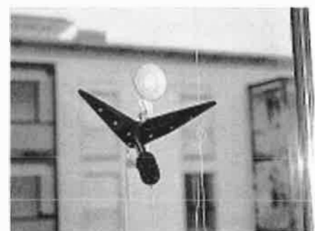
Mikrofon auf der Fensteraussenseite bei der Messung der Fassade-Luftschalldämmeigenschaften
