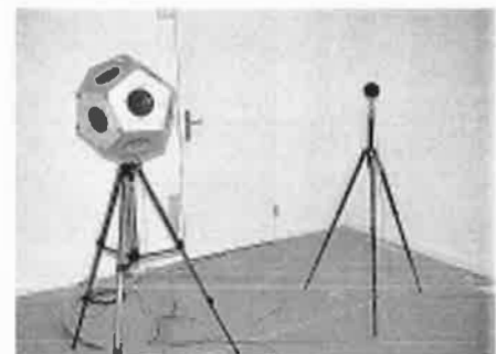
Lautsprecher und Mikrofon bei der Messung zur Durchlassöffnung
