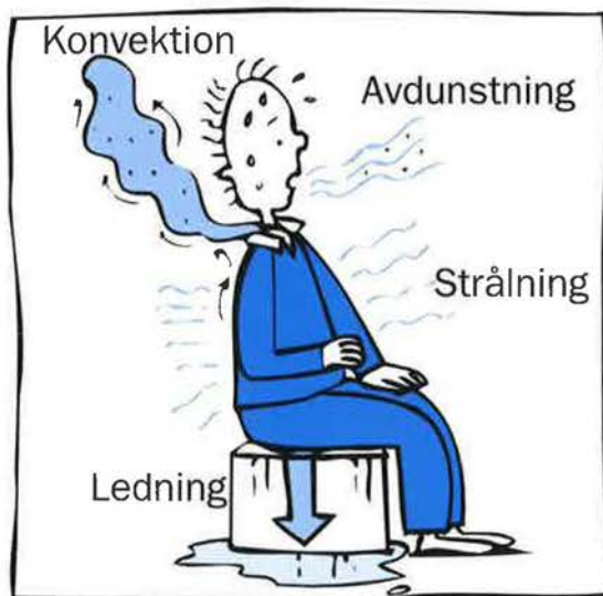
Bild 1: Kroppens fyra sätt att avge värme.
