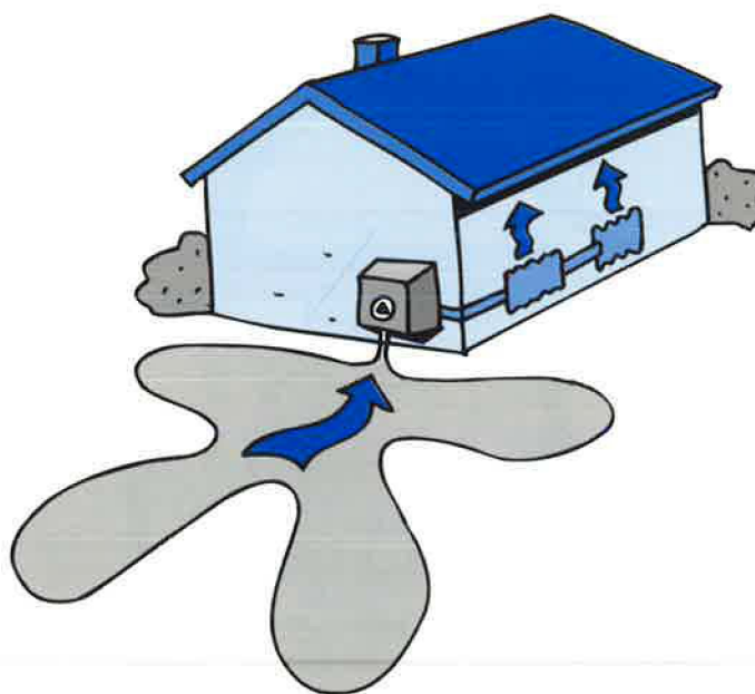
Bild 5: Ytjordvärmepump. Typ: Vatten/vatten.
