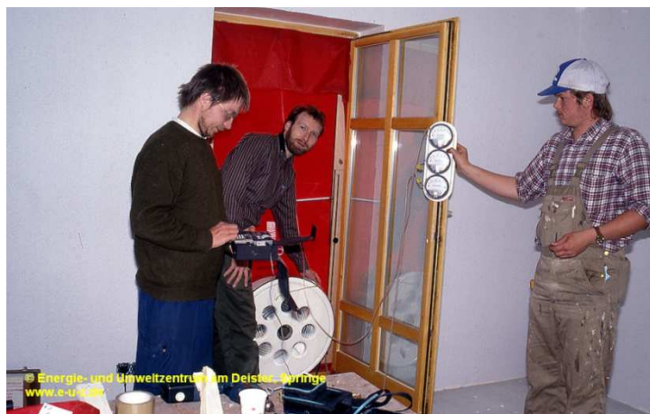
Bild 1: Peter Merl und Wilfried Walther (e·u[z]) testen das Minneapolis- BlowerDoor-Modell 2, mit Drehzahlregelung am Gehäuse und analogen Druckmessdosen.
