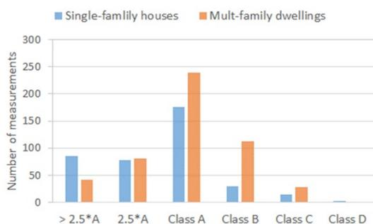
Figure 3: Distribution des classes d'étanchéité à l'air mesurées dans les bâtiments résidentiels [11] – traduit en français
