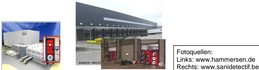
Abb. 1: Zwei Gebäude mit je 200.000 \text{ m}^3 Gebäudeluftvolumen. Das linke Gebäude ist sehr dicht mit V_{50} = 2.600 \text{ m}^3/\text{h} , das rechte hat einen V_{50} = 86.500 \text{ m}^3/\text{h} .
