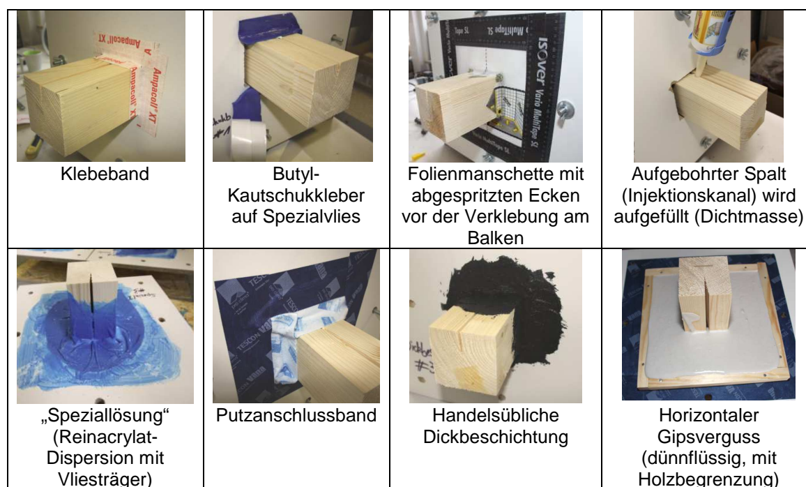
Abbildung 1: Beispielbilder der unterschiedlichen Abdichtungsmethoden [Peper 2013]
