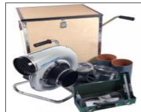
Fig. 3. Exempel på utrustning för täthetsprovning av kanaler
