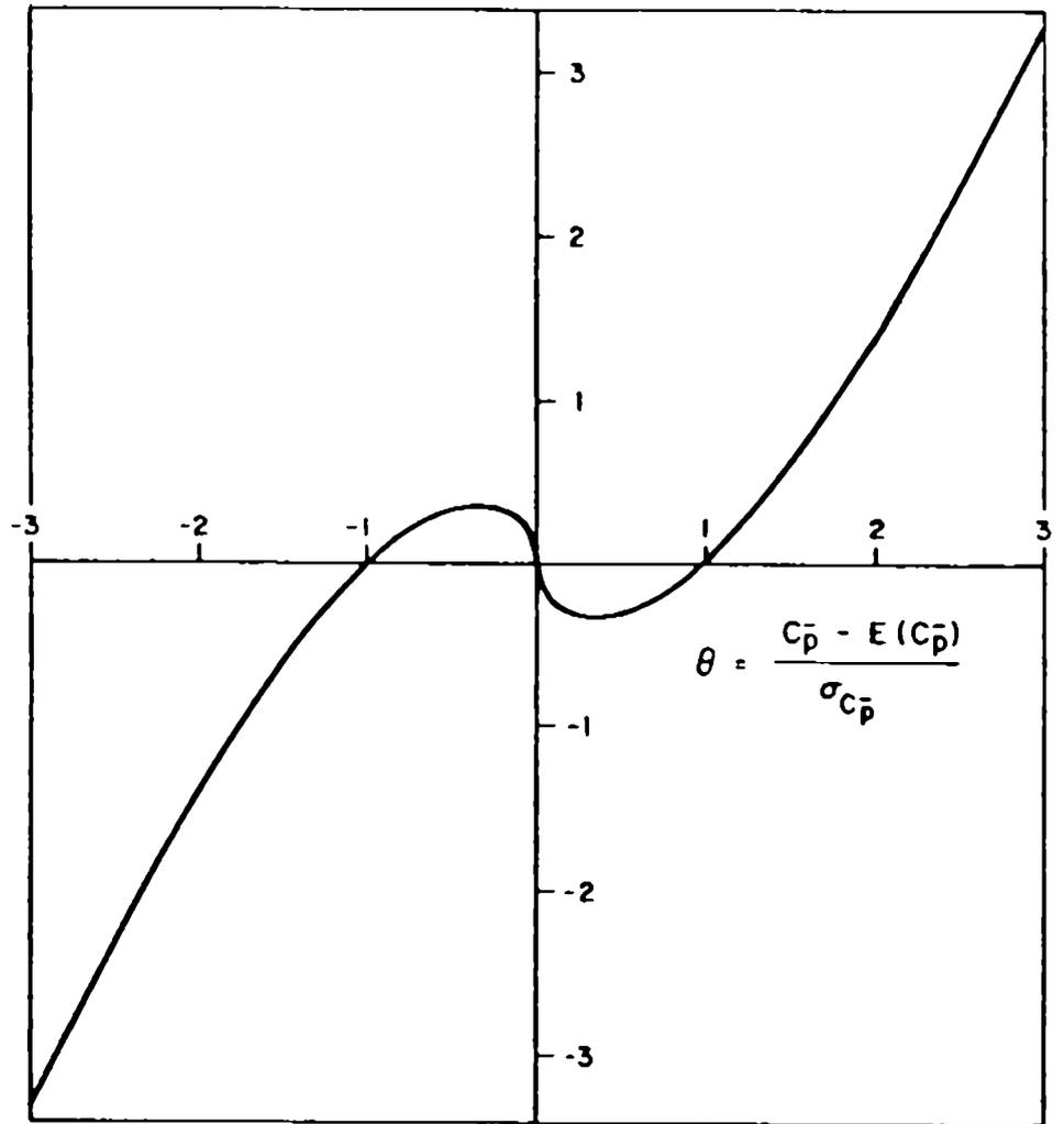
**FIG. 3** WEIGHTING FUNCTION FOR ESTIMATION OF INTERNAL PRESSURE FROM STATISTICAL DISTRIBUTION OF PRESSURE COEFFICIENTS
