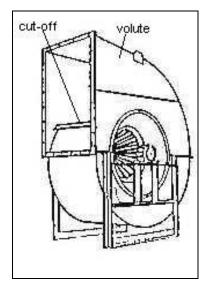
Figure 4 Centrifugal fan
