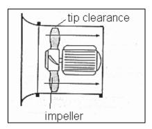
Figure 2 Axial flow fan
